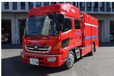
水槽付き消防ポンプ車
