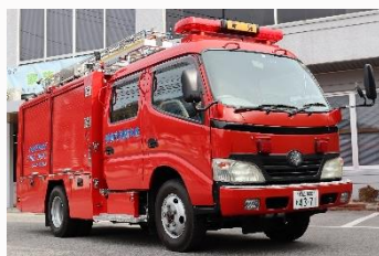
消防ポンプ車
