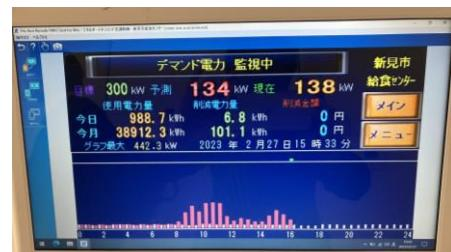
新見市学校給食センターには、EMS（デマンドコントロールシステム）を導入し、電力消費量の削減に努めています。
