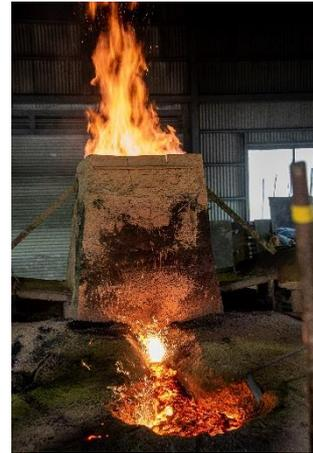
写真 3-2 たたら製鉄 (再現操業)
