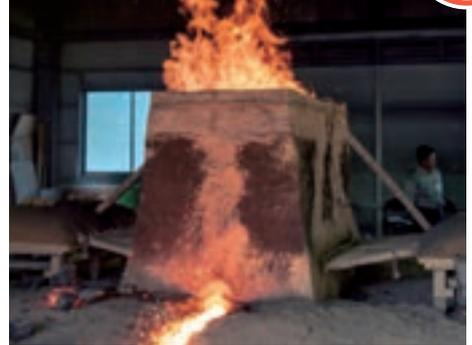
「たたら製鉄」は、木炭の熱を利用して砂鉄から鉄を得る日本古来の製鉄方法です。新見庄で行われている「中世たたら」の復元操業への参加者を募集します。新見の歴史を学び、たたら製鉄を体験しませんか。
