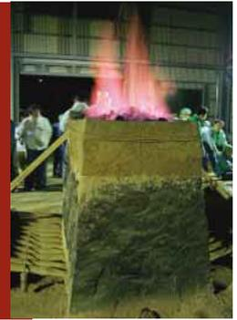
「たたら製鉄」は、木炭の熱を利用して砂鉄から鉄を得る日本古来の製鉄方法です。
