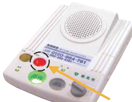
通報ボタンが赤色に点灯=通報可能
