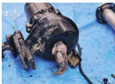
異物がつまったマンホールポンプ
